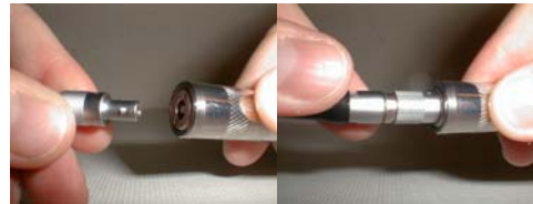
2. Sondenkabel mit Gammasonde verbinden
