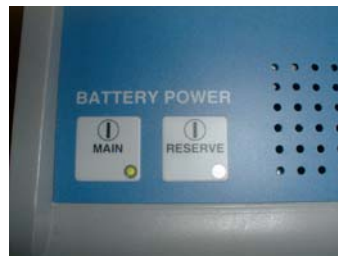
4. Taste „Main“ drücken, um das Gerät einschalten
