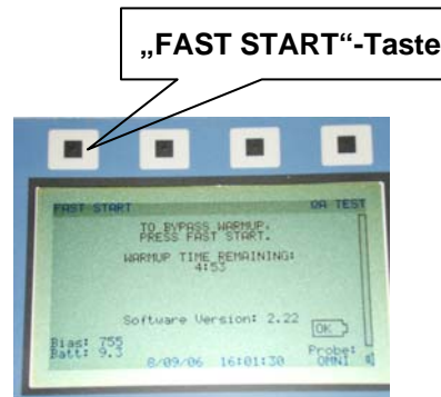
5. Aufwärmphase startet, mit der Taste „FAST START“ abbrechen
