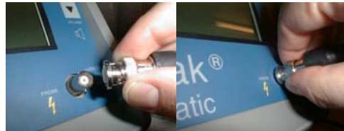
1. Das Gerät ist ausgeschaltet. Sondenkabel an der Gerätevorderseite mit Stecker befestigen
