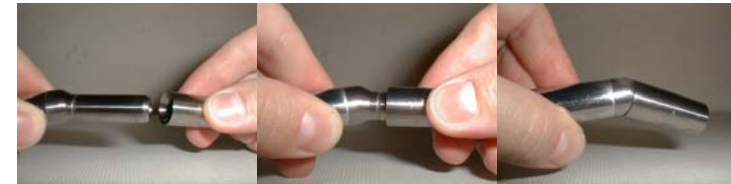
3. Standard- oder Lechnerkollimator auf die Sonde stecken
