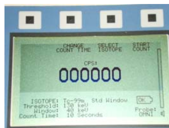
7. Arbeitsbildschirm, eingestelltes Nuklid überprüfen, AUF STERILITÄT DER SONDE ACHTEN
